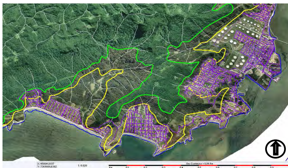
Figura 1 – Composição da região central do Município de São Sebastião/SP com sobreposição de layers temáticos e aerofoto; linha verde – limite do PESMar (cota 200), linha amarela – limite do Tombamento da Serra do Mar (cota 40), linha branca – micro-bacias, linha lilás – edificações. Escala 1:6.006.
