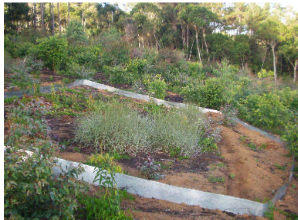
Figura 2 – Parcela para coleta de escoamento superficial de água de chuva com cordão de contorno, Março de 2007, Viçosa – MG.
